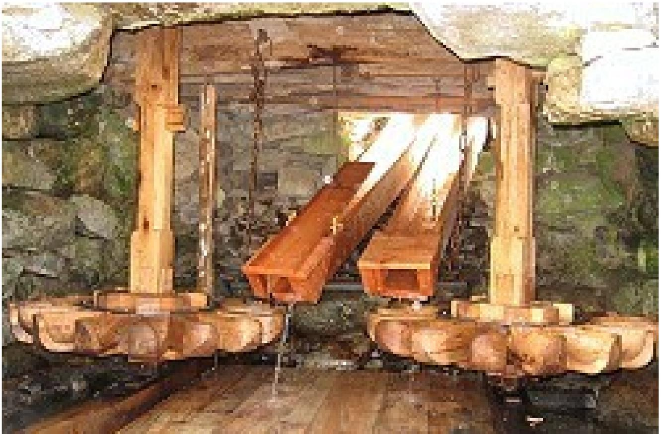
Deux roues horizontales à pales cyclopéennes avec gouttières en conduite forcée
