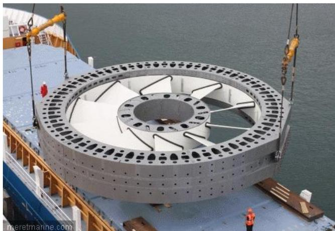
Turbine d'hydrolienne (© : DCNS)
