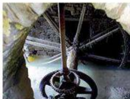
La roue à aubes est d'origine, protégée de la dégradation par l'épaisse couche de vase sous laquelle elle était enfouie.
